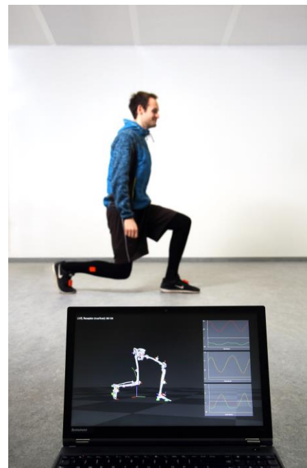
AG wearHEALTH: Bewegungsanalyse des unteren Körpers auf Basis sieben tragbarer Sensoren an Becken, Beinen und Füßen
